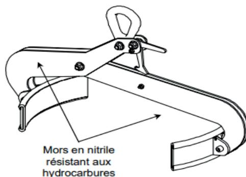
Pinces pour le levage de fûts métalliques standard en position verticale (capacité 225 litres).
