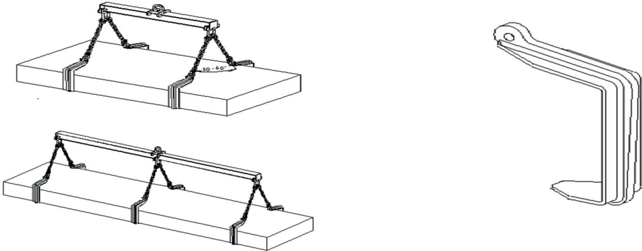
Crochets simples pour levage de plaques horizontales unitaires ou en paquet.
