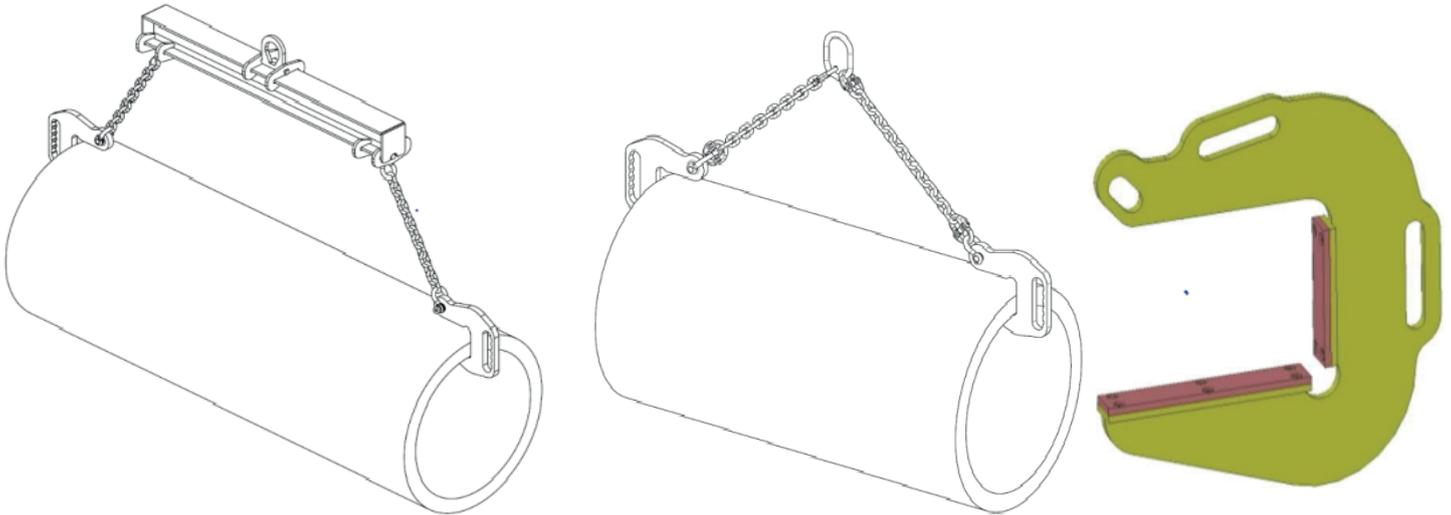
Crochet pour levage de tuyaux ou tubes horizontaux en matériaux divers unitaires ou en paquet.
