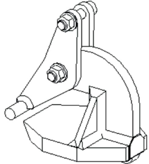
Pinces pour le levage de tôles en position horizontale, unitaires ou en paquet, de tôles circulaires ou d'ensembles mécano-soudés.
