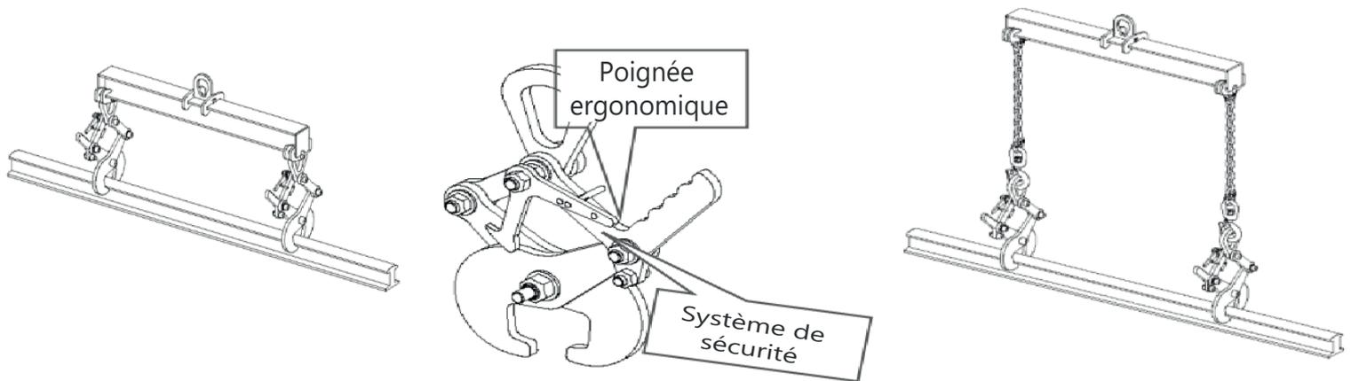
Suspendre la pince par l'anneau, en position ouverte crochet de maintien enclenché.
