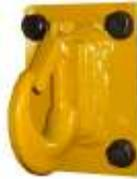
**Crochets boulonnés sur le bâti**
