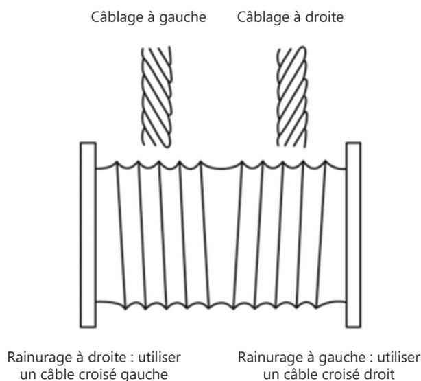
Pour éviter tout risque de détachement du câble, il est important de laisser au minimum 2 à 3 tours de câbles morts sur le tambour. L'enroulement du câble nécessite une pré-tension suffisante (5-10% de la CMU du câble), afin d'éviter tout risque d'écrasement et d'aplatissement du câble.
