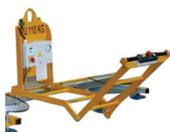
Remplacement du bras standard par un bras articulé, permettant à l'opérateur de garder les commandes à portée de main pour les prises au sol comme en hauteur.
