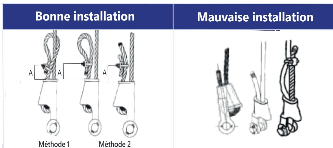
**Méthode 1 :** le brin mort forme une boucle qui doit être fermée à l'aide d'un serre-câble EN 13411-5 et ligaturée ou bouclée sur le brin porteur. Si un risque d'accrochage de cette boucle à un obstacle est présent lors de l'utilisation de la boîte à coin, il est impératif de recourir à la méthode 2.
